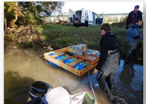
Figure 28: Radeau pour la mise en place des hydrophones
