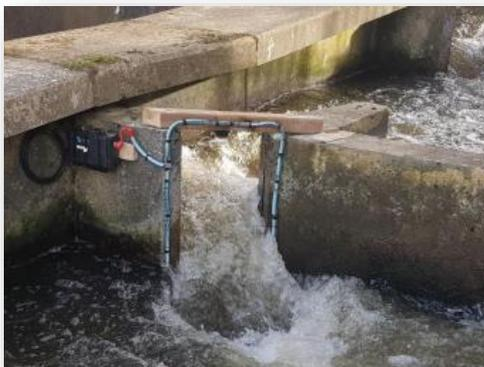
Figure 84: Antenne de réception RFID (source: Fish Pass)
