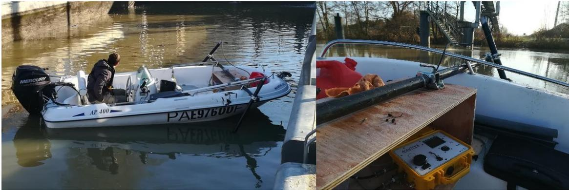
Figure 30: Positionnement des hydrophones mobiles dans le bateau
