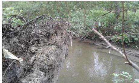
Températures erronées en raison d'une exondation de la sonde
